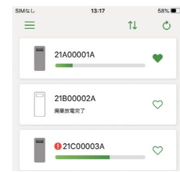
Bluetooth®通信で複数のイープロックの状態を遠隔で状態確認できます。バッテリー残量低下時や異常発生時にプッシュ通知も可能です。
