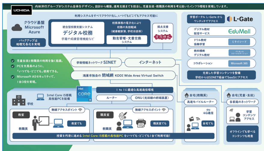
鴻巣市のICT環境整備後の構成図： 統合型校務支援システム、 教育コンテンツ配信サービス 「EduMail」や学校向け教育ポータル 「L-Gate」が稼働。
